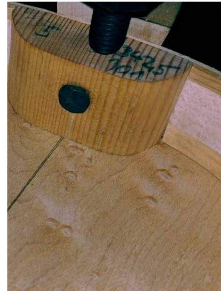
Bei vielen anderen Instrumenten besteht der Korpus aus einem Kasten, der aus Boden, Seitenwänden (Zargen) und Decke aufgebaut ist. Damals war es üblich, die Zargen auf dem Boden aufzusetzen und den Korpus frei aufzubauen. Eine andere Möglichkeit ist, eine Außenform zu verwenden: in ein Holzbrett, das so dick ist, wie die Zargen hoch sind, wird ein Loch in der Umrissform der Zargen gearbeitet. Das dient der präzisen Formtreue für das Biegen und Verleimen des Zargenkranzes.
