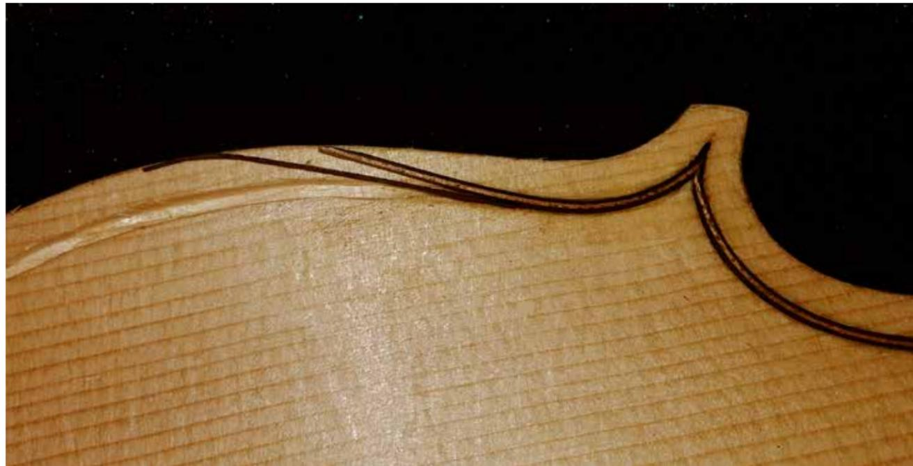
Nach dieser Einlage wird insbesondere im Randbereich die Feinarbeit vollendet und alle Oberflächen für das Auftragen von Grundierung und Lack „geputzt“. Dann ist die Holzarbeit im Wesentlichen fertig.
