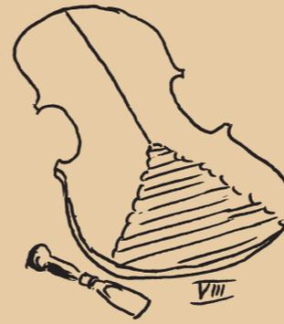
Anschließend wird die Wölbung mit verschiedenen Bildhauereisen gestochen, mit kleinen Hobeln geformt und mit Ziehklängen geglättet (Skizze VIII & IX).
